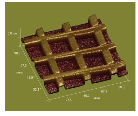
Рис. 1: ACM-изображение плазмонной дифракционной решётки из пористого германия с наночастицами серебра, сфрмированной ионной имплантацией.
