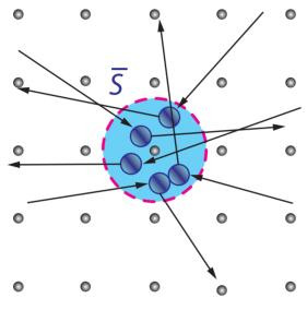
Рис. 1: Эффективный локальный момент S (распределённый в области, ограниченной красной штриховой линией), возникающий при хундовском обмене между электронами (голубые кружки) вблизи одного из узлов кристаллической решётки (чёрные точки).
