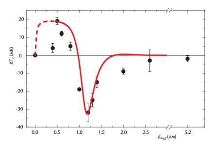
Рис. 2: Зависимость величины эффекта спинового клапана  $\Delta T_{\rm c}$  от толщины слоя Fe2. Красная линия – теория.
