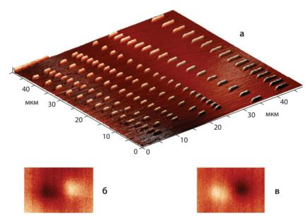
Рис. 1: Наночастицы пермаллоя, полученные методом сканирующей зондовой нанолитографии (a); магнитно-силовое изображение частицы пермаллоя, находящейся в состоянии «0» (б) и «1»
