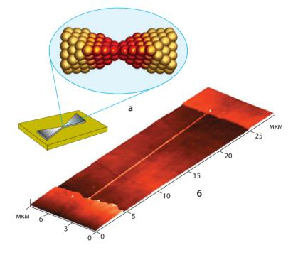
Рис. 1: Схема наноконтата, полученного электрохимическим методом (а); нанопроволока никеля сечением 10х100 нм², сформированная между двумя контактными площадками методом сканирующей зондовой литографии (б).
