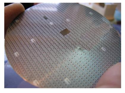
Рис. 1: Пластина Si (D = 76 мм), содержащая ~2000 микрочипов с магнитными наноструктурированными элементами, сформированными методом ИЛС.
