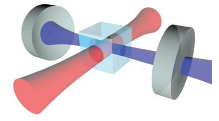
Рис. 1: Схема оптической квантовой памяти на основе непрерывного управления пространственным синхронизмом в резонаторе. Красный пучок – управляющее поле, синий пучок – сигнальное поле. Область пересечения пучков находится в примесном кристалле – носителе квантовой информации, который помещается в резонатор. Запись и воспроизведение сигнального поля осуществляется путём угловой модуляции управляющего пучка.
