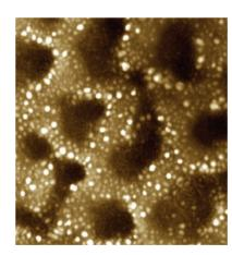
Рис. 2: СЭМ-изображение пористого кремния с ионно-синтезированными наночастиами серебра.
